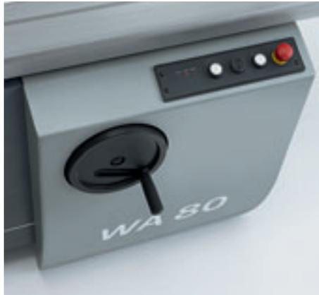
■ **Das Bedienpaneel am Maschinenständer:** Auf dem Bedienpaneel am Maschinenständer sind die Steuerungsfunktionen übersichtlich angeordnet. Die Höhenverstellung des Hauptsägeblatts erfolgt manuell per Handrad.
