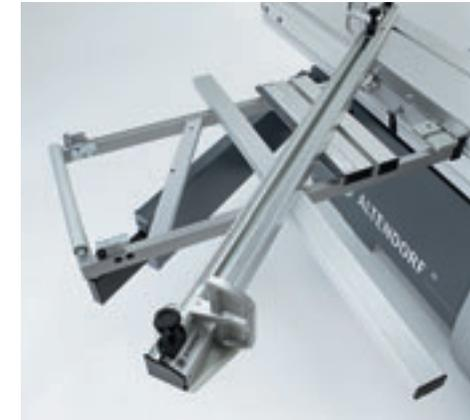
■ **Der Winkel-Gehrungsanschlag:** Dieser Anschlag erleichtert das präzise Schneiden von Winkeln und Gehrungen in einer Funktion. Der Wechsel zwischen der vorderen und hinteren Position auf dem Querschlitzen erfolgt ohne Anheben des Anschlags. In beiden Positionen ist der Schwenkwinkel stufenlos um  $49^\circ$  verstellbar und wird über eine Maßskala angezeigt. Selbst bei geschwenktem Anschlag ist eine große Werkstückunterstützung vorhanden.
