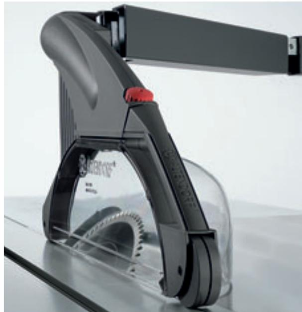
■ **Die Absaughaube:** Die große Altendorf Schutzhaube überzeugt durch eine strömungsoptimierte Konstruktion. Mit wenigen Handgriffen lässt sie sich von breit auf schmal umstellen. Die Haube ermöglicht eine maximale Schnitthöhe von 125 mm (unabhängig vom Vorritzaggregat) und ist komplett seitlich wegschwenkbar. Optional erhältlich für WA80NT und WA80T.
