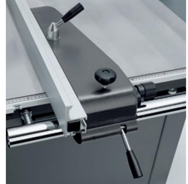
■ **Parallelanschlag mit manueller Feineinstellung:** Die manuelle Feineinstellung erleichtert die präzise Einstellung des Parallelanschlags. Per Verstellerschraube wird der Anschlag millimetergenau justiert.
