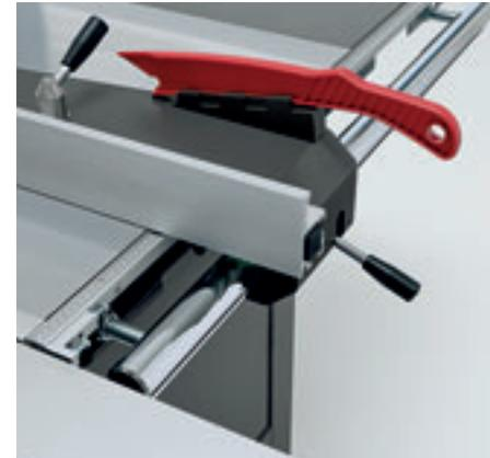
■ **Der Parallelanschlag:** Der Parallelanschlag ist leichtgängig und präzise verstellbar. Seine Leichtgängigkeit erhält der Anschlag über das hart verchromte Rundstangensystem. Sollen große Platten aufgeteilt werden, kann er mit einem Griff unter die Tischebene geschwenkt werden.
