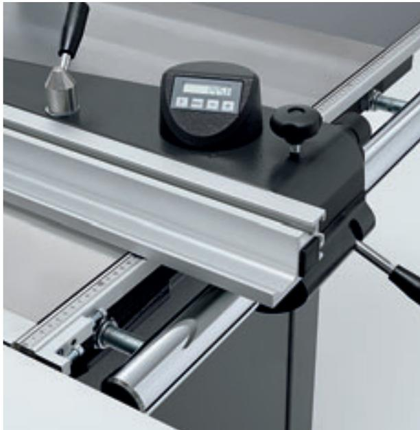
■ **DIGIT X:** Digitale Schnittbreitenanzeige des Parallelanschlags mit manueller Feineinstellung. Dieses elektronische Mess-System garantiert die genaue, schnelle Einstellung des Parallelanschlags. Wiederkehrende Schnittwerte sind exakt reproduzierbar und in der DIGIT X Anzeige abzulesen. Das System ist staubunempfindlich und arbeitet verschleißfrei. Beim Umlegen der Anslagschiene in die aufrechte bzw. flache Position erfolgt die Maßkorrektur automatisch.
