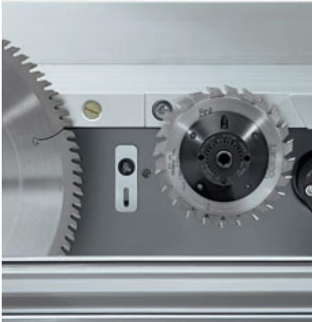
■ **Elektromotorischer Vorritzer:** Der Vorritzer ermöglicht ausrissfreie Unterseiten beim Sägen von beschichtetem Plattenmaterial. Die Höhenverstellung erfolgt elektromotorisch, die Seitenverstellung manuell. Mit Einschalten des Vorritzsägeblatts fährt der Vorritzer automatisch auf die Arbeitsposition bzw. beim Ausschalten zurück unter die Tischplatte. Das Vorritzaggregat hat eine Antriebsleistung von 0,75 kW bei 8200 U/min.
