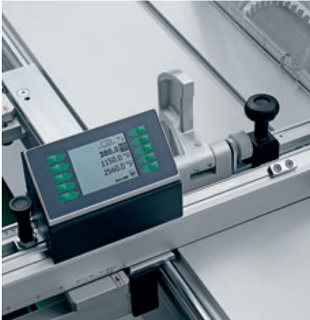
■ **Winkelanschlag DIGIT L:** Zum 1/10 mm genauen Einstellen des Längenmaßes. Das Display zeigt alle eingestellten Klappenmaße an. Durch die zentrale Mess- und Anzeigeeinheit wird mit einem einzigen Kalibriervorgang das komplette System geeicht. Für die WA80X ist außerdem der DIGIT LD erhältlich: Er zeigt zusätzlich die Winkel digital an. Ein  $\pm 1/100^\circ$  genaues Einstellen ist möglich. Das Längenmaß wird abhängig vom Gehrungswinkel automatisch berechnet. Probeschnitte entfallen.
