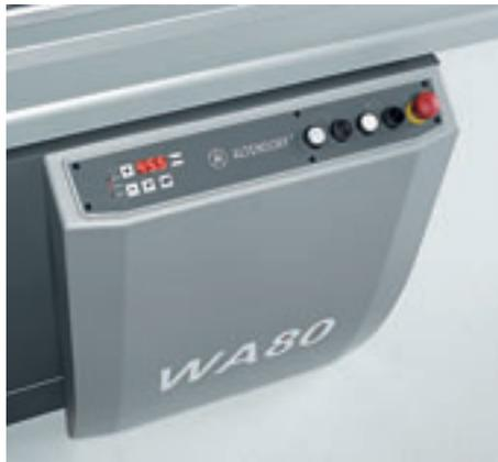
■ **Das Bedienpaneel am Maschinenständer:** Auf dem Bedienpaneel am Maschinenständer sind alle Funktionen übersichtlich angeordnet. Per Knopfdruck steuern Sie die Höhen- und Schwenkverstellung des Hauptsägeblatts. Der Schwenkwinkel wird im digitalen Display gut lesbar angezeigt.
