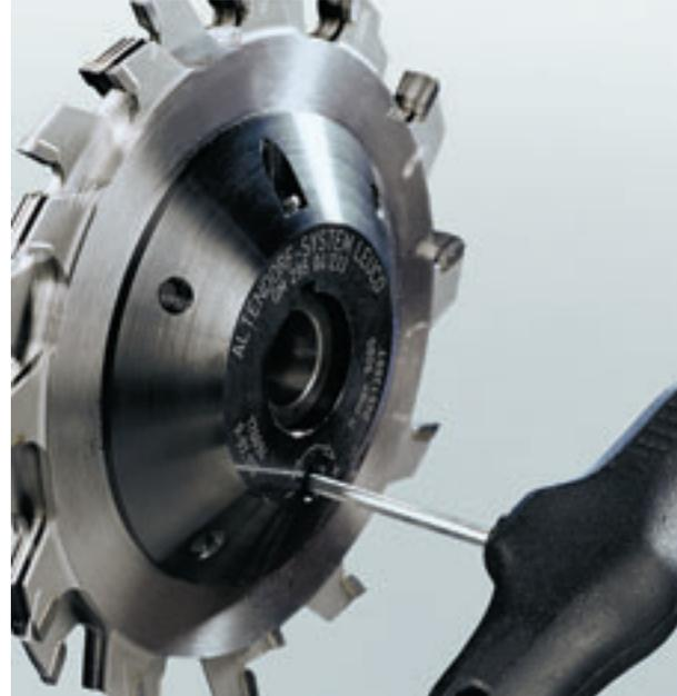
■ **RAPIDO Vorritzwerkzeug:** Der RAPIDO erleichtert und beschleunigt die Schnittbreitenverstellung. Dauer: max. drei Minuten. Gegenüber herkömmlichen Vorritzsystemen sparen Sie mindestens zehn Minuten Einstellzeit, da das mühsame Montieren von zweigeteilten Vorritzblättern mit Distanzscheiben entfällt. Die Schnittbreite des Vorritzblattes kann ohne Demontage stufenlos auf die Schnittbreite des Hauptsägeblattes eingestellt werden. Einstellbereich: 2,8–3,8 mm.
