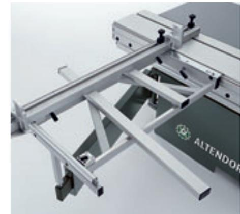
■ **Der Winkelanschlag:** Der robust gelagerte Winkelanschlag ermöglicht das präzise Schneiden von 90°-Winkeln. Alle Einstellwerte sind über die schräg angeordneten Maßskalen gut ablesbar. Die spielfreien und robusten Anschlagklappen können leicht verschoben und als Einzelklappe über den gesamten Ablängbereich eingestellt werden.
