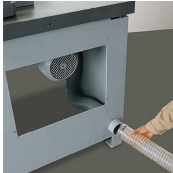
*Absaugstutzen am Maschinenständer (Absaugstutzen: Ø 90 mm).*
