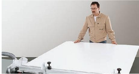
Die Platte ausrichten und einen Besäumschnitt durchführen.
