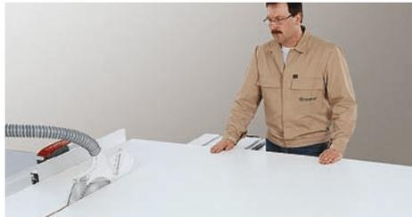
Plattenstreifen am Parallelanschlag aufschneiden.
