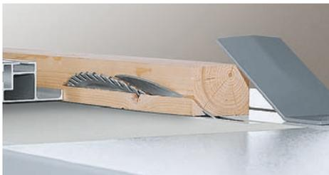
Das Werkstück unter dem Klemmschuh befestigen und Fase schneiden.
