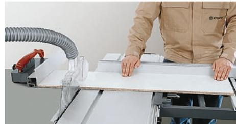
Plattenstreifen am Parallelanschlag auf Fertiglänge schneiden.
