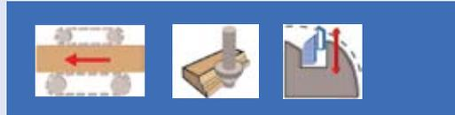
Anwendung: Speziell für große Profilausladungen beim Fräsen von Kanten-, Kassetten- und Kranzprofilen etc. auf stationärer Oberfräse und CNC-Bearbeitungszentrum
