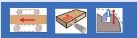
Anwendung: Zur Herstellung von Schlosskasten- und Stulpausfräsungen bei stufenweiser Zustellung. Konstanter Durchmesser durch Wendepplatten-Ausführung
