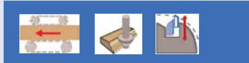
Anwendung: Zum Fräsen von tiefen, beidseitig geschlossenen Profilen, wie z.B. Halbstabprofile bis R = 25 mm
