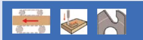
Anwendung: Herstellung von Spionloch und Drückerlochfräsungen. Spionloch und Drückerlochfräsungen werden durch Einbohren oder spiralisches Ein-tauchen hergestellt
