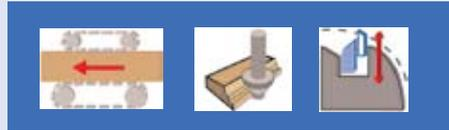
**Anwendung:** Zum Fräsen von Kanten-, Kassetten-, Kranzprofilen etc. auf stationärer Oberfräse und CNC-Bearbeitungszentrum. Einbohren möglich, bei gleichzeitiger Bewegung in Vorschubrichtung
