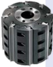
Anwendung: Zum Feinsthobeln. Empfohlene Spanabnahme 0,5 - 0,8 mm
