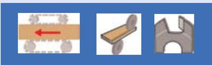
Anwendung: Vorräsen Kunststoffkante, Bündigfräsen Massivholzkante
