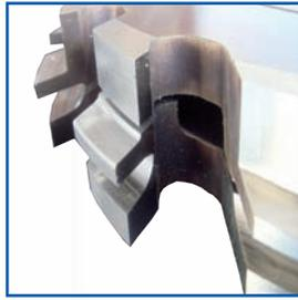
Anwendung: Zum Profilieren auf Mehrspindel - Kehlautomaten
