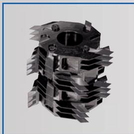
**Anwendung:** Zum Fräsen von selbsthemmenden Längsverbindungen in Weich- und Harthölzern für tragende Bauteile nach DIN 1052 sowie im Fensterbau, in der Fußboden- und Leistenherstellung. Satzweiser Aufbau je nach Holzdicke mit ein oder mehreren Fräsern.
