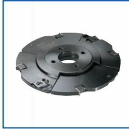
Anwendung: Zum Nuten in Holz- und Plattenwerkstoffen, längs und quer zur Faser
