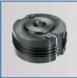
Anwendung: Zum Fräsen von Verleimverbindungen. Das Profil und Gegenprofil wird mit dem gleichem Werkzeug auf Umschlag gefräst.
